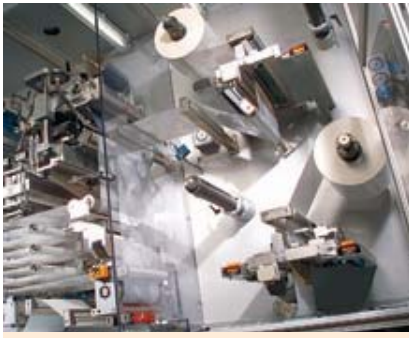
Zuführung von 2-lagigem Folienlaminat zur Herstellung von Beuteln
