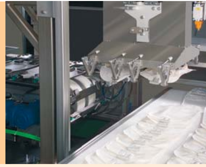
Zweifache Pick-and-Place-Einheit zum Übersetzen auf ein Austragband
