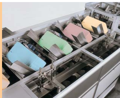
On-line Sortierung von Faltschachteln mit unterschiedlichen Farben und Bedruckungen
