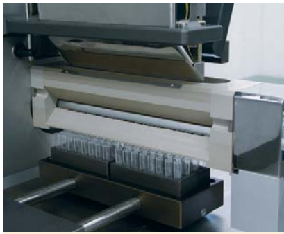
Die Labormaschine zur Pulverdosisierung von Kleinstmengen mit höchster Präzision
