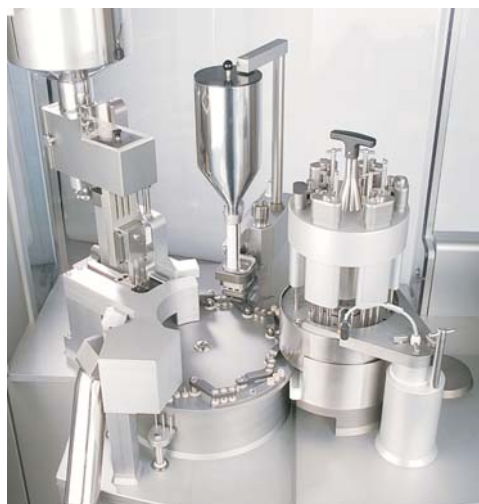
Die Basis für einen verlässlichen Wägeprozess – der Rundläufer der Modu-C.
