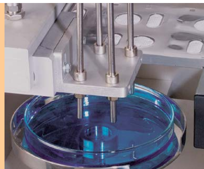
Dosieren des Wirkstoffes – inkl. In-Prozess-Kontrolle über Wiegetechnik
