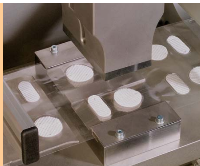
Ultraschall-Schweißstation zum Fixieren der Vliespads in der Trägereinheit
