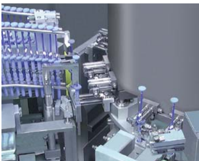
Einsetzen der Spritzen vom Liftsystem in den Rundläufer
