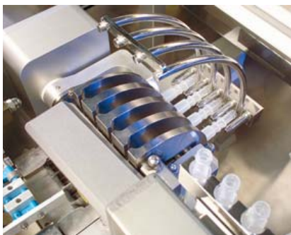
Einsetzen der Injektorkörper, Montage und Befüllung
