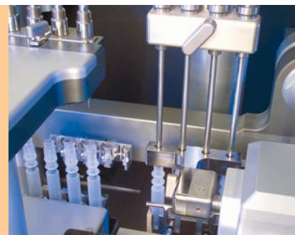
Dosieren des Wirkstoffs in die zuvor gedrehten Injektoren
