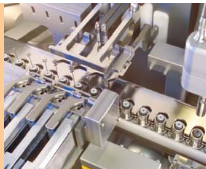
Einsetzen der Nadeln in die Stopfen und Discs
