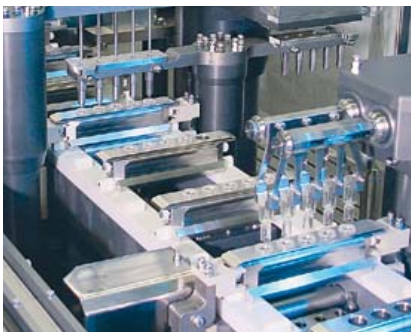
Montagestraße zum Komplettieren der Injektoren-Komponenten
