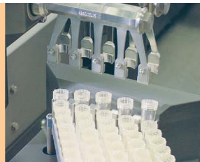
Übergabe der Injektoren-Komponenten mittels Greifer
