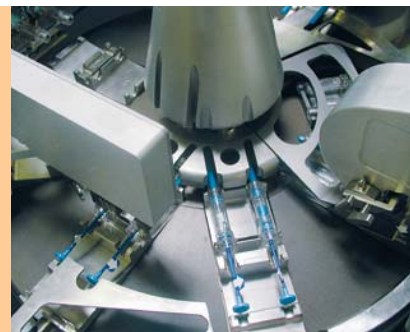
Einsetzen von Spritzen in Schutzhülsen
