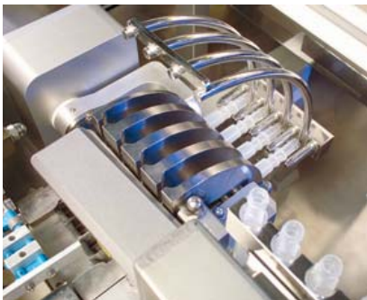
Einsetzen der Injektorenkörper, Montage und Befüllung
