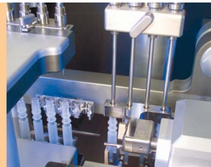
Dosieren des Wirkstoffs in die zuvor gedrehten Injektoren
