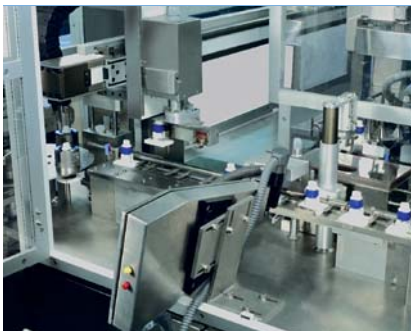
Tara-Brutto-Verwägung mit Laserkennzeichnung und Schlechttteilentnahme
