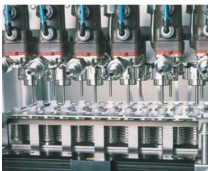
Befüllen von Kartuschen über CIP/SIP-fähige Füllköpfe
