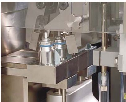
Eindrücken der Kartuschen in die Zähler-Unterseite
