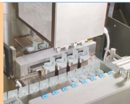
4-faches Übersetzen der Unterteile in den Rundläufer
