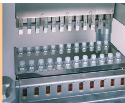
Prüfen der Deckel auf korrekten Sitz
