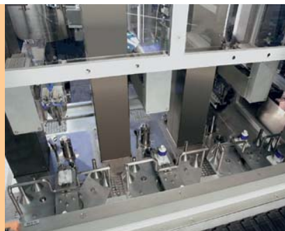
Rundläufer zur Endmontage des Inhalators mit Funktionstest
