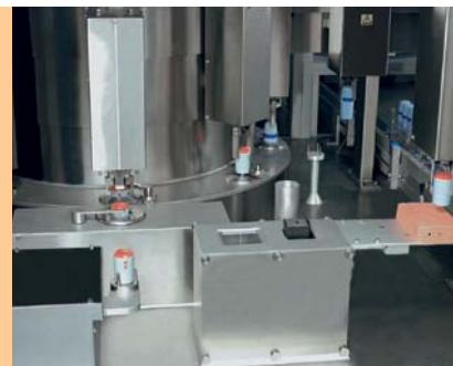
Pulverfüllung und Kompaktierung in der Pulverkammer
