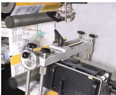
Codierung mit Heißprägedrucker und anschließender Druckbildkontrolle
