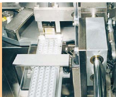
Zuführen von gefüllten Diagnosekapseln in eine Montagemaschine
